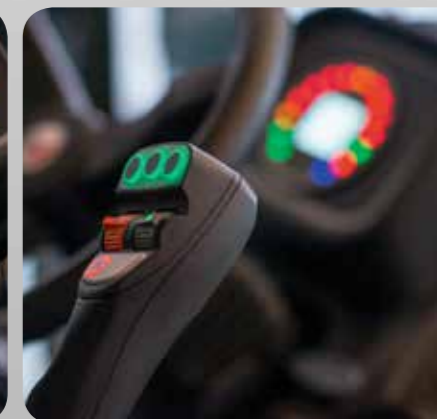
Koneen ja työlaitteiden herkkä ja täsmällinen ohjaus hydraulisella esiohjatulla joystick-hallinnalla.
